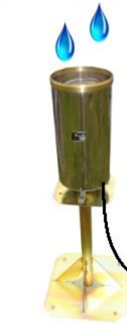
転倒まず型雨量計 (気象庁認定品)
